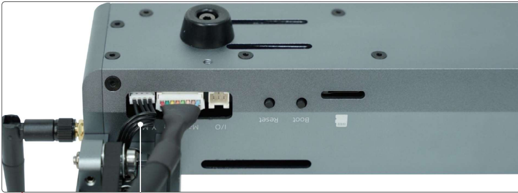
Câble moteur axe Y / Groupe de circuits *1
